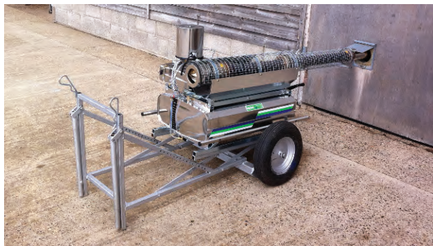
Rysunek 4. Zamgławiacz termiczny (Dzięki uprzejmości Agrex Limited)
